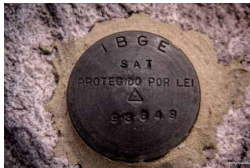
Fig. 2 – Ponto de uma rede geodésica materializado no espaço físico. Fonte: [12].
